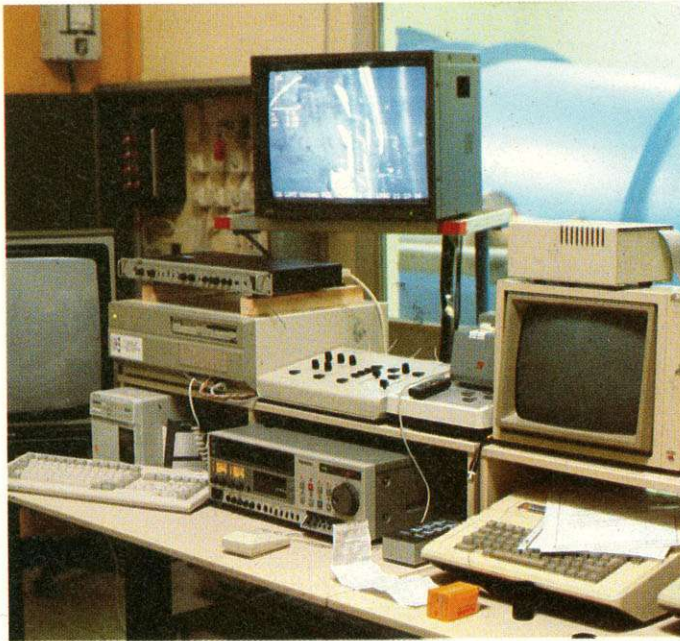
Steuerstand des Windkanals mit der Videokommentierungsanlage. Im Hintergrund ist der Windkanal sichtbar.
